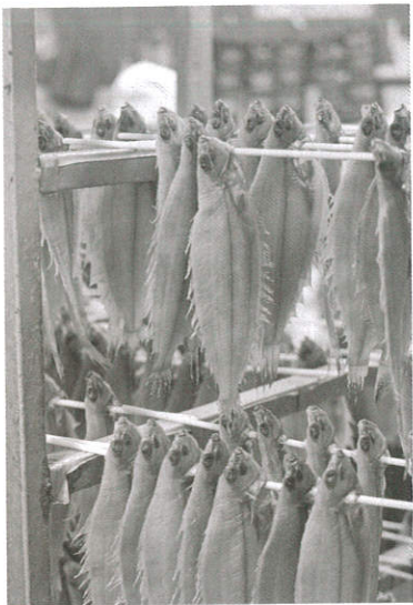
冷風乾燥機でしっかりと干し上げる。乾燥温度や時間は季節や魚種によって調整する
